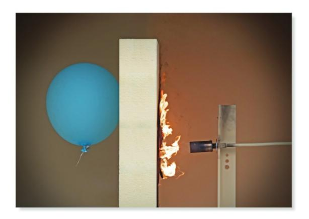
✔ MedWall มีฉนวน PIR (Polyisocyanurate) ซึ่งมีคุณสมบัติเดียวกันกับ FIWall by Wall Tech ให้ประสิทธิภาพที่ดีเยี่ยมด้านการเป็นฉนวนกันความร้อน เพื่อช่วยประหยัดการใช้พลังงานไฟฟ้า และมีคุณสมบัติ กันไฟ ไร้ควัน เพื่อลดความเสี่ยงและความสูญเสียจากอัคคีภัย
